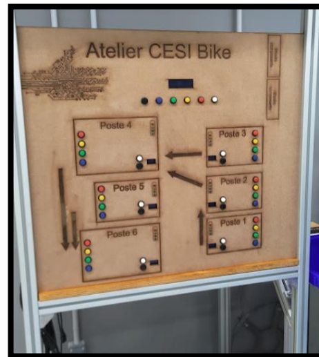
Figure AH : Maquette pilotage andons via JN
