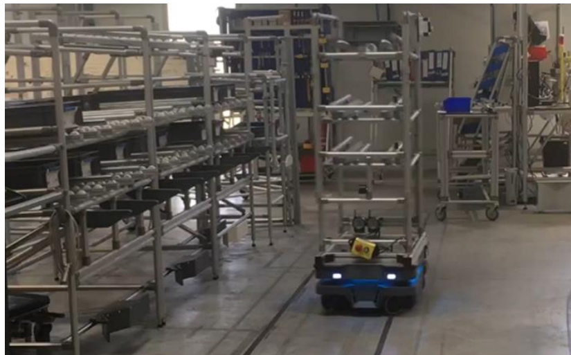
Figure E : AMR (Autonomous Mobile Robots) allant récupérer une caisse vide
