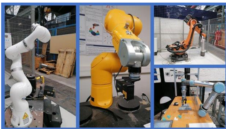
Figure E : Des robots et cobots : 3 Kuka iiwa 14kg, 1 Kuka KR300, 1 UR10e, 1 URS et 1 Doosan M0609
